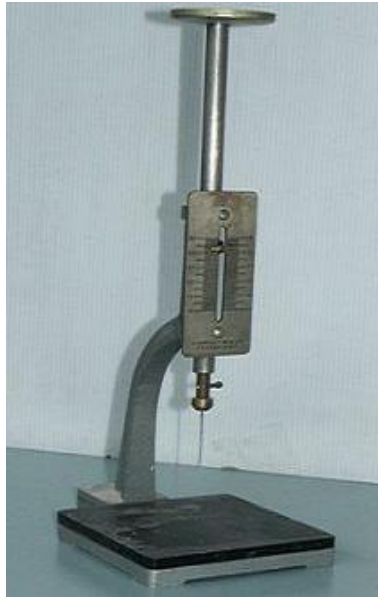
( fig. 10) Vicat Apparatus
