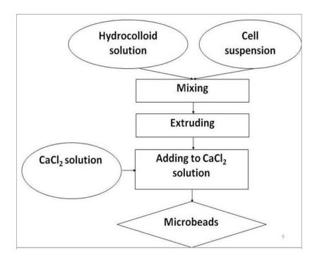
Fig. 3. Extrusion Method
